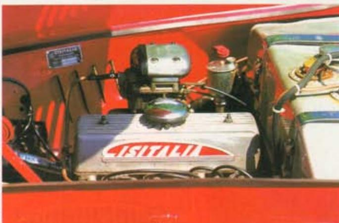
Unter der profilierten vorderen Haube hockt das kleine 1,1-Liter-Motörchen mit 68 mm Bohrung und 75 mm Hub. Der Zylinderkopfdeckel verrät unübersehbar seine Herkunft.
