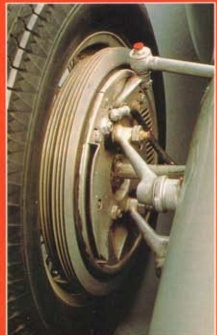
An den vorderen Bremsen sorgten an den Außenrändern Verrichtungen für Kühlung
