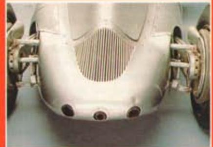
Deutlich zu erkennen ist die Belüftung der hinteren Trommelbremsen
