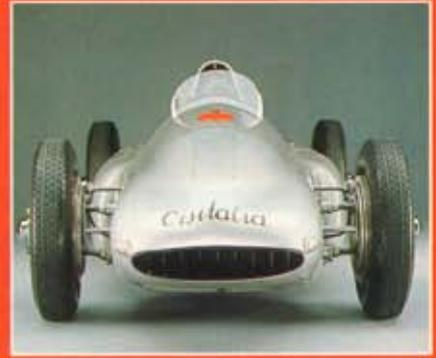
Heißer Hai: Die Öffnung im Bug diente der Frischluftzufuhr des Öl- und Wasserkühlers
