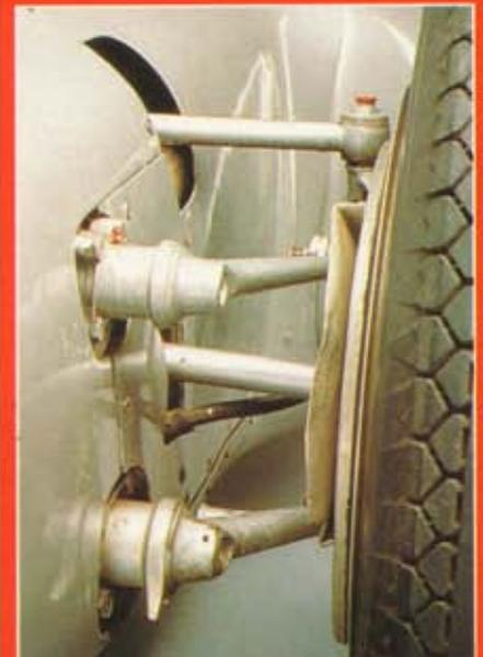
Beim Einfedern bleiben die Räder der Vorderachse ohne Sturz- und Spurveränderung
