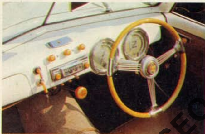
L'elegante posto guida della «202». Il volante era quasi sempre a destra e la leva del cambio sul pavimento. Nei due strumenti circolari c'erano il tachimetro, l'indicatore livello benzina e l'orologio; poi contagiri, manometro olio e termometro acqua.
