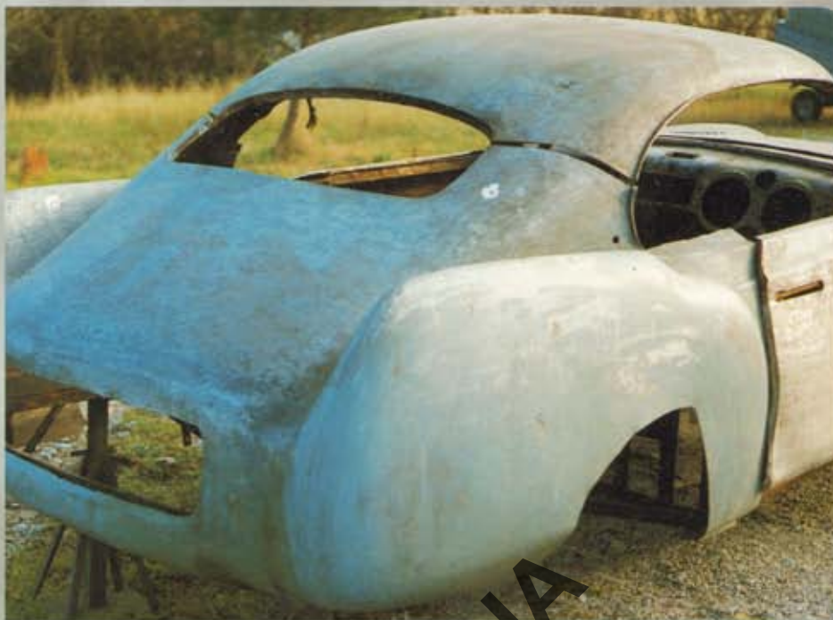
All'inizio di un superficiale tentativo di restauro, fortunatamente interrotto, la riproduzione della parte esterna delle pinne posteriori è stata terminata senza completare il giro ruota.
