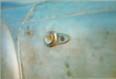
L'apertura a pulsante delle portiere è una delle caratteristiche delle prime (e perciò tra le più rare) berline completamente assemblate dalla Carrozzeria Pinin Farina.
