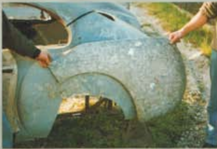
Il pannello originale del parafrangente posteriore, consumato dal tempo ma perfettamente recuperabile, è sopra a quello ricostruito.
