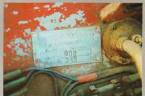
La targhetta di identificazione della vettura mostra sia il numero del motore sia quello del telaio. Le sigle sono fedelmente riportate, comunque, anche su entrambi gli organi.
