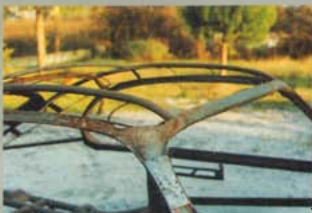
La struttura del padiglione della 033 mostra le tracce di ruggine provocate dal lungo adagiamento sotto la carrozzeria in alluminio. La sabbatura è necessaria per eliminarle. A destra, ancora l'ossatura in tubi di acciaio.
