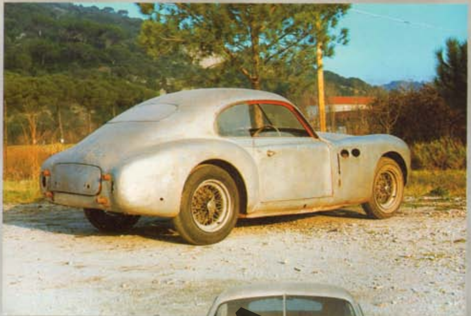
Sopra, una vista di tre quarti posteriore della numero 008. Le ruote andranno sostituite perché di larghezza maggiore rispetto alle originali. Il frontale (a lato) rivela l'assenza della tipica mascherina a ventitré stecche verticali.
