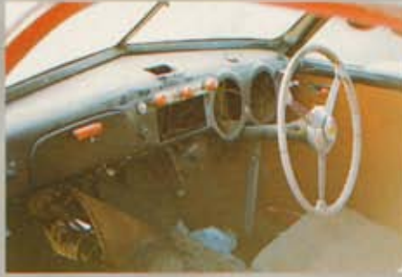
Nella plancia della 008 mancano gli strumenti ma non si nota alcuna alterazione. Il volante con corona in bachelite presenta sul pulsante del clacson lo stambecco simbolo della Casa.
