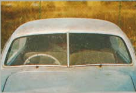
Il parabrezza della berlina «202», nella prima versione, comprende due elementi separati di cristallo piatto temperato, delimitati da una sottile cornice di alluminio.
