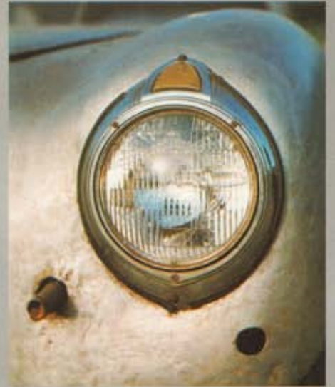
Il caratteristico fanale anteriore della Cisitalia «202» è racchiuso da una pregiata cornice in ottone cromato. Subito sopra è previsto invece l'alloggiamento della luce di posizione.
