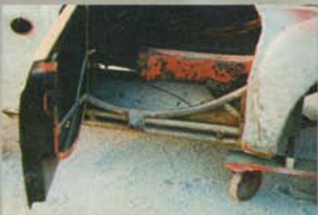
Il tubo ricurvo di rinforzo al telaio dell'auto non penalizza l'accesso a bordo. Sotto, il serbatoio del carburante, in alluminio, ha una sagomatura perfettamente dritta.
