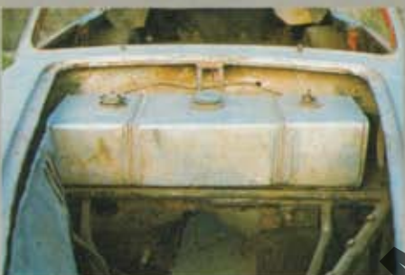
Il tubo ricurvo di rinforzo al telaio dell'auto non penalizza l'accesso a bordo. Sotto, il serbatoio del carburante, in alluminio, ha una sagomatura perfettamente dritta.
