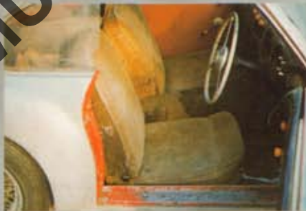
È impossibile il recupero della tappezzeria originale della 008. Ma il discreto stato di conservazione di alcune sue parti aiuterà gli esperti nella più fedele riproduzione.
