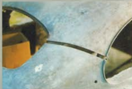
L'ossatura della carrozzeria della berlina fissata per la saldatura al telaio tubolare. La scocca d'acciaio, che riproduce il disegno della vettura, sostiene la lamiera in alluminio.
