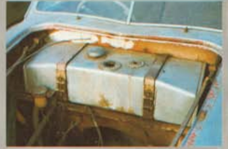
Il serbatoio in alluminio delle berline «202», alloggiato nel vano motore, è caratterizzato da entrambi i lati obliqui per consentire l'apertura del cofano da destra o da sinistra.
